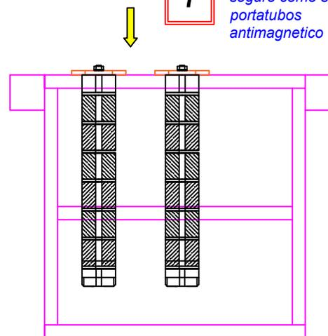
**8** Limpiar la grilla sin sus tubos magneticos internos mediante un trapo con un poco de agua / alcohol.
